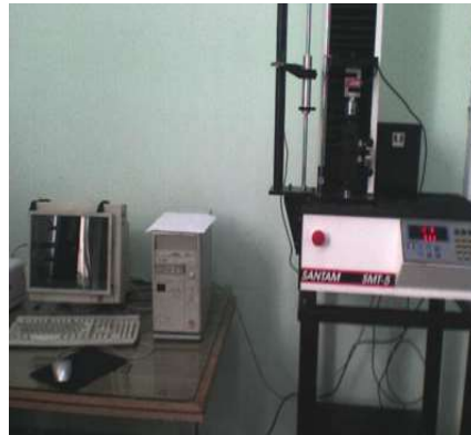
شکل ۱: تصویر دستگاه SMT-5 برای اندازه گیری خواص مقاومتی محصولات کشاورزی
