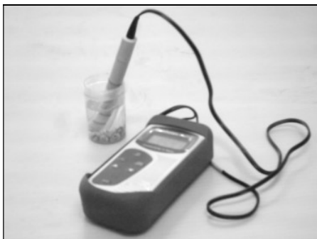
شکل ۱. سنجش هدایت الکتریکی محلول حاصل از خیساندن بذور گندم در آب مقطر به روش توده ای.
