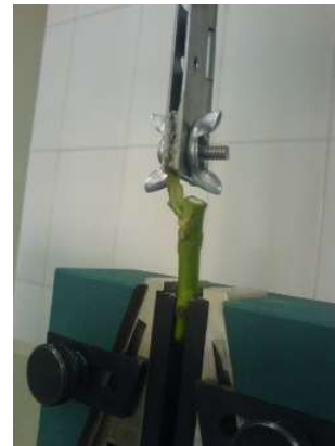
شکل ۴: وسیله برای نگاه‌داشتن برگ و اتصال آن به دستگاه اینسترون
