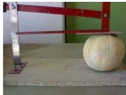
شکل ۱. یک ابزار مخصوص برای اندازه گیری ابعاد میوه های بزرگ
