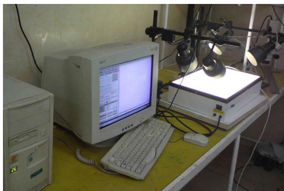
شکل ۱- دستگاه سطح برگ سنج برای اندازه‌گیری مساحت سطح
