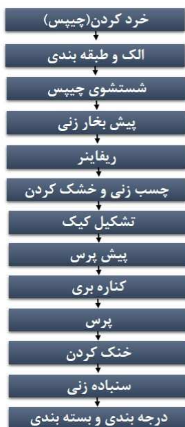
شکل ۱- فرآیند تولید تخته فیبر چگالی متوسط (MDF)
