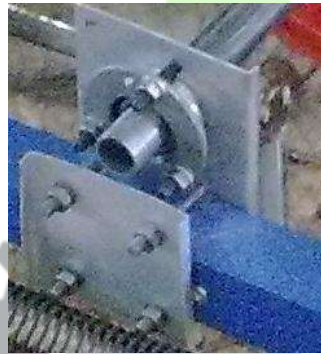
شکل ۴. تکیه گاه بلبرینگ طراحی و ساخته شده برای محور غلتک ها.
