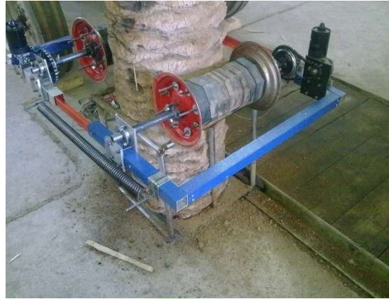
شکل ۵. ماشین آزمایشی ساخته شده با غلتک‌های اصلاح شده لاستیکی.
