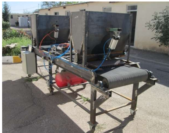
شکل ۳- ربات کشت بذر درون سینی نشاء
