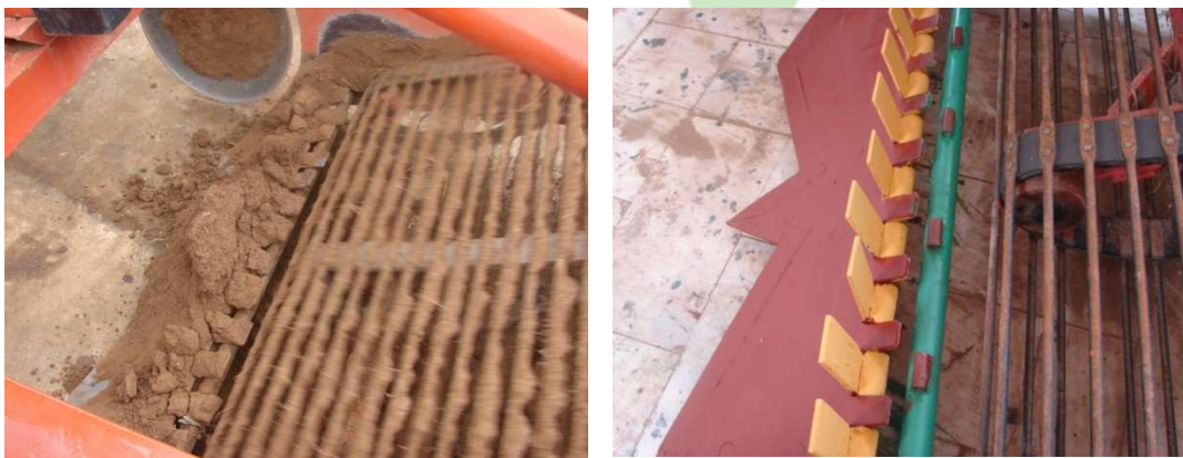
شکل ۲- محور و پره‌های ضربه زن و نحوه کارشان
