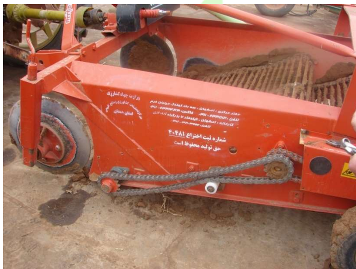
شکل ۴ - سیستم انتقال توان
