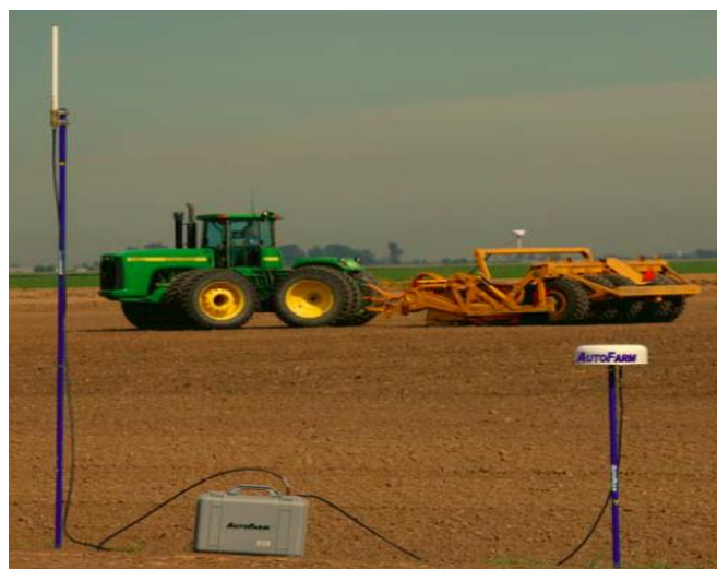
شکل ۷- گیرنده و فرستنده ثابت امواج ماهواره، مستقر در مزرعه
