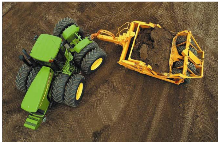
شکل ۴- اسکرپیرکشی در حالت کار در مزرعه
