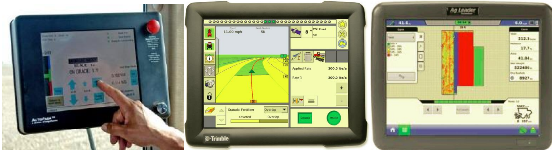
شکل ۲- صفحه قابل لمس ساده واحد کنترل ماشین تسطیح مجهز به سامانه مکان‌یاب جهانی
