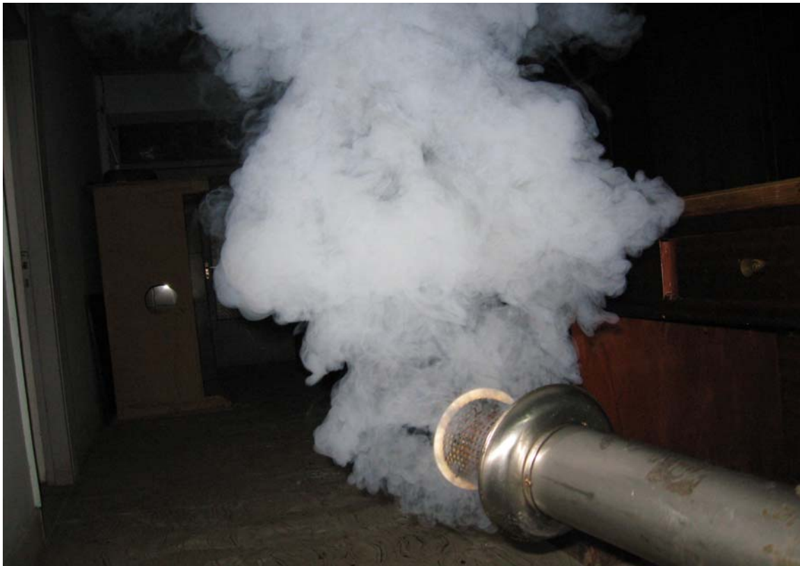
شکل ۲: تولید ذراتی در حد نانو از فارچ کش اورتوفنیل فنال توسط دستگاه الکتروفاگر
