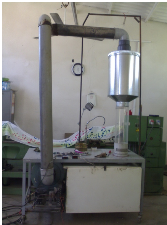
شکل-۱. ۱) خشکن بستر سیال مورد استفاده در آزمایش ، ۲) دما سنج و رطوبت سنج دیجیتال ، ۳) سرعت سنج (ANEMOMETER)
