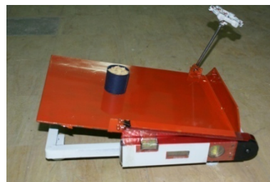
شکل ۱- دستگاه اندازه‌گیری زاویه اصطکاک استاتیکی
