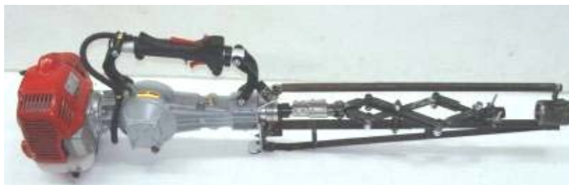
شکل ۱. شیکر به کاررفته در آزمایش‌ها به همراه مکانیزم تغییر دامنه (قلاب شیکر در تصویر نشان داده نشده)
