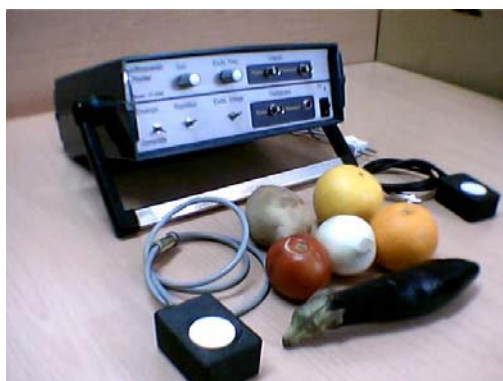
شکل ۳- سامانه UQS100 به همراه تراگذرهای ۷۵ kHz و نمونه‌هایی که آزمایش اولیه شدند.
