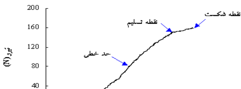
شکل ۲- نمونه منحنی نیرو- تغییر شکل دانه ذرت حاصل از بارگذاری شبه استاتیک
