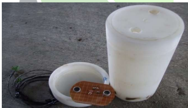
شکل ۳. حسگر اندازه‌گیری محتوای رطوبت و دمای بسته‌های علوفه.
