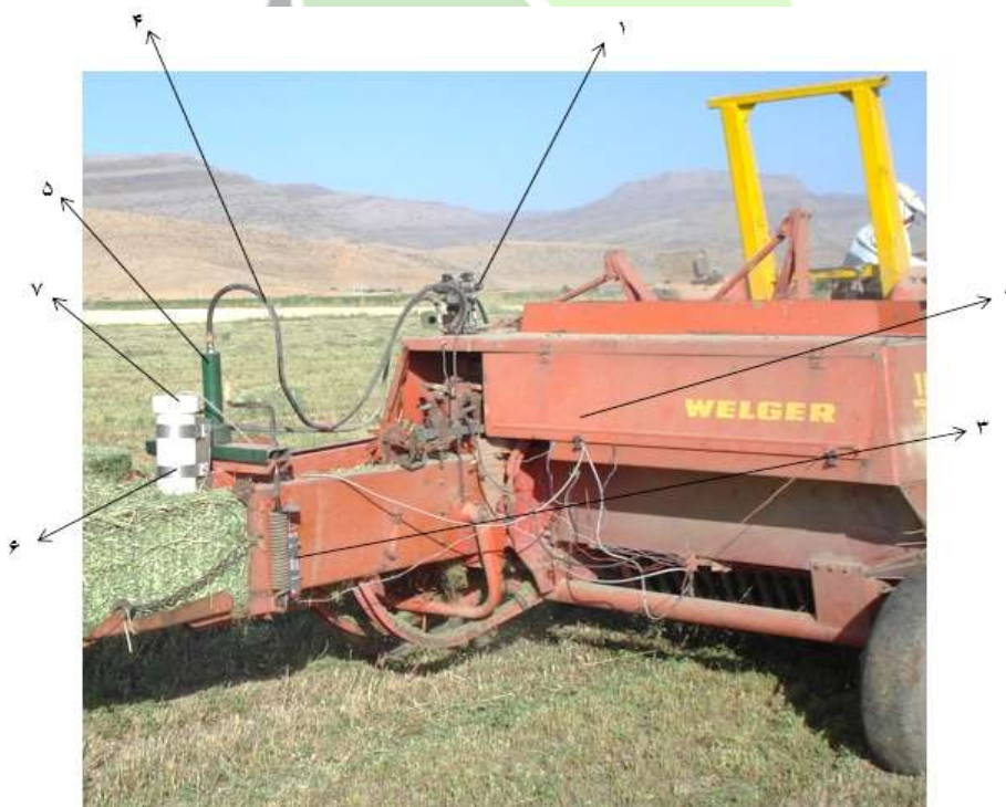
شکل ۷. نصب دستگاه روی بسته‌بند و اجزای مختلف آن: (۱) شیر کنترل جهت جریان، (۲) محل قرارگیری برد، (۳) خط کش الکترونیک، (۴) شیلنگ‌های هیدرولیک، (۵) جک دو طرفه هیدرولیک، (۶) شاسی طراحی شده حسگر رطوبت و (۷) حسگر رطوبت.
