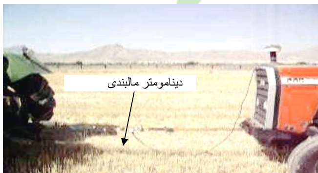
شکل ۲-۸- روش اندازه‌گیری مقاومت کششی افقی به وسیله دینامومتر مالبندی.
