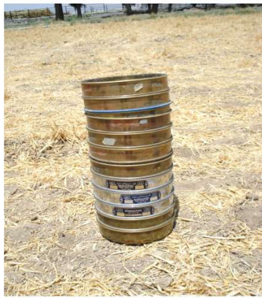
شکل ۲-۱۰- الک های مطبق استفاده شده برای اندازه گیری MWD.
