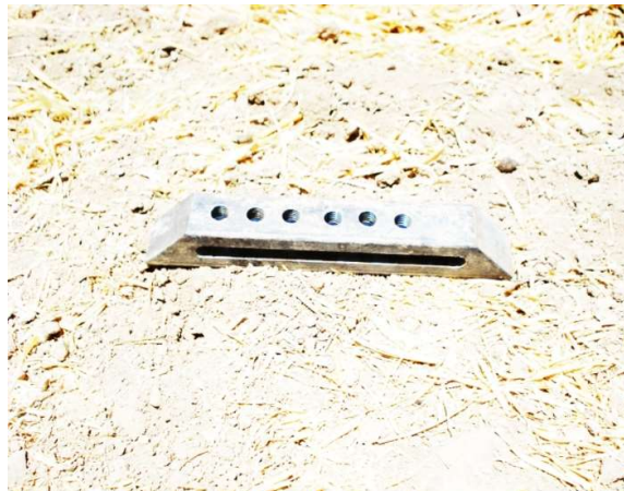
شکل ۲-۵- نوک گوه‌ای دوزنقه‌ای با زاویه حمله ۴۵ درجه.
