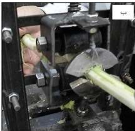
شکل ۴. الف: مکانیزم طراحی شده، ب: مکانیزم ساخته شده جهت پوست کنی ساقه استبرق
