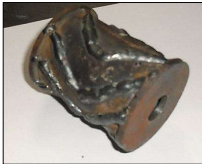
شکل ۳. غلتک شیاردار به کار رفته در مکانیزم
