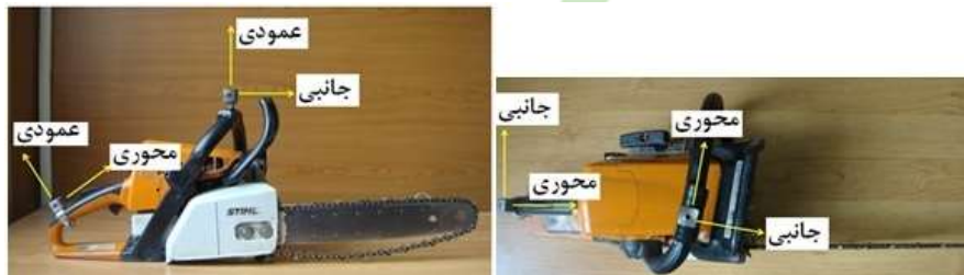
شکل ۱- پایه‌های حسگر بر روی دسته جلو و عقب و جهت‌های اندازه‌گیری ارتعاشات
