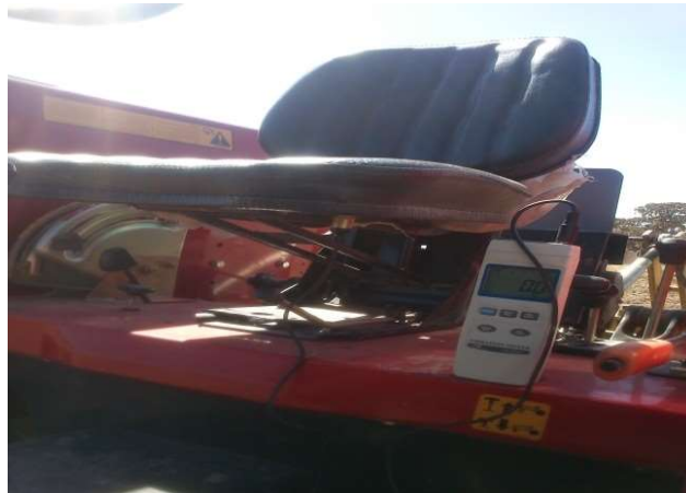
شکل (۲): محل و نحوه اتصال سنسور به صندلی تراکتور
