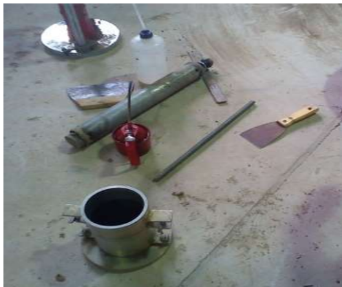
شکل ۳: انجام آزمایش تراکم استاندارد
