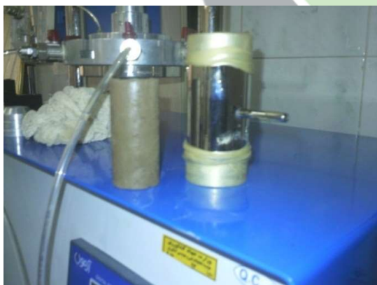
ب) قرار دادن غشا بر روی استوانه
