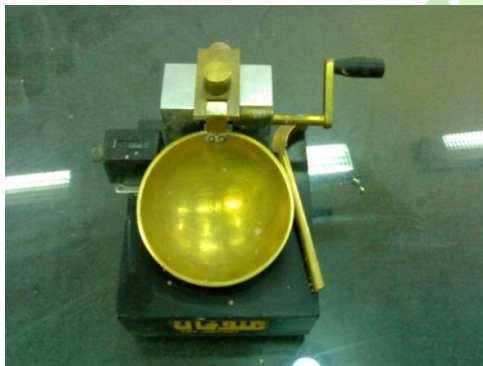
شکل ۲: دستگاه کاساگراند برای تعیین حد روانی خاکهای رسی
