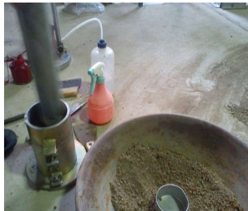
شکل ۳: انجام آزمایش تراکم استاندارد
