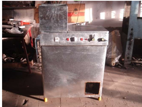
شکل ۲. ماشین جدا کننده کلاله از سایر اجزای گل
