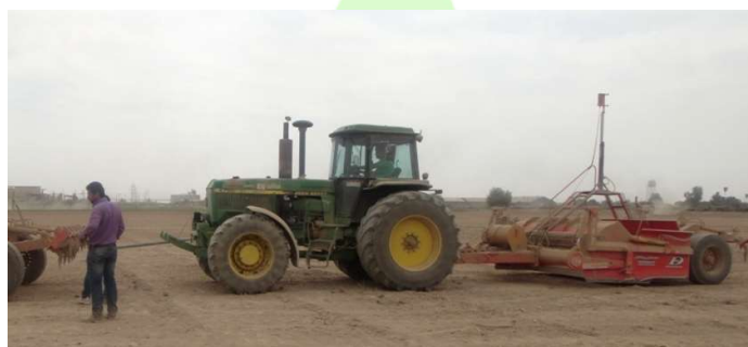
شکل ۴. مجموعه اسکرپیر و تراکتور حامل توسط تراکتور کشنده و نیروسنج بین آنها
