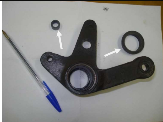
شکل ۲. برینگ‌های گرافیتی سامانه کلاچ‌گیری تراکتور MF399
