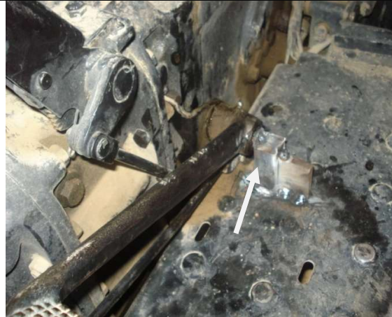
شکل ۶. ثابت نمودن پین محور پدال در مکانیزم کلاچ‌گیری تراکتور MF285
