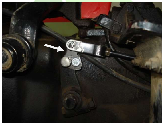
شکل ۵. قطعه سه سانتی‌متری اضافه شده به قطعه چدنی اهرم محور کلاچ
