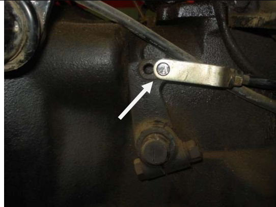
شکل ۴. امکان تعبیه شده در سامانه کلاچ‌گیری تراکتور MF285 در وضعیت عدم استفاده از مرحله دوم کلاچ‌گیری
