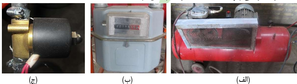
شکل ۴. بخش‌های واحد هوا رسانی (الف) کمپرسور هوا (ب) دبی‌سنج (ج) شیر الکتریکی پنوماتیک
