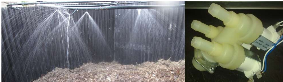
شکل ۴. سیستم آب‌رسانی دستگاه هوشمند تولید کمپوست
