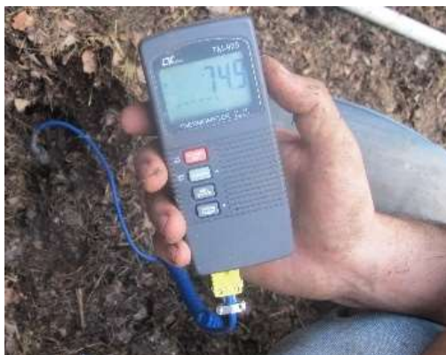
شکل ۷. اندازه‌گیری دمای مخلوط در دستگاه هوشمند تولید کمپوست
