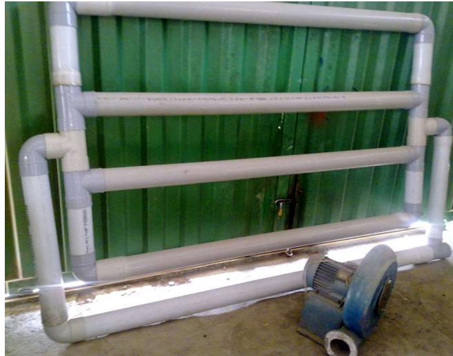
شکل ۵. سیستم هوادهی دستگاه هوشمند تولید کمپوست
