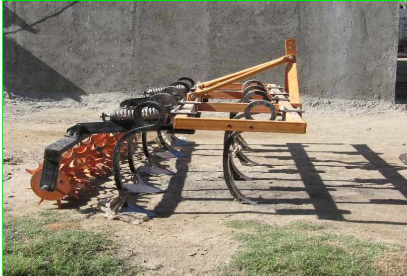
شکل ۱ - دستگاه چیزل پکر مورد استفاده در آزمایش
