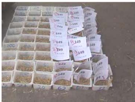
شکل ۵- نحوه ثبت مواد دانه ای جداشده در کوبنده و ریخته شده در سلول ها
