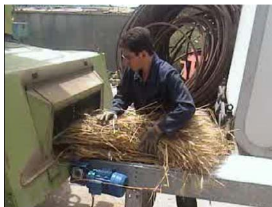
شکل ۴- نحوه ی تغذیه مواد به نقاله تغذیه کمباین
