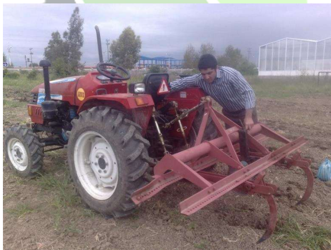
شکل ۲- تراکتور آروید ۳۵۴ به همراه گاواهن چیزل مورد استفاده در آزمایش
