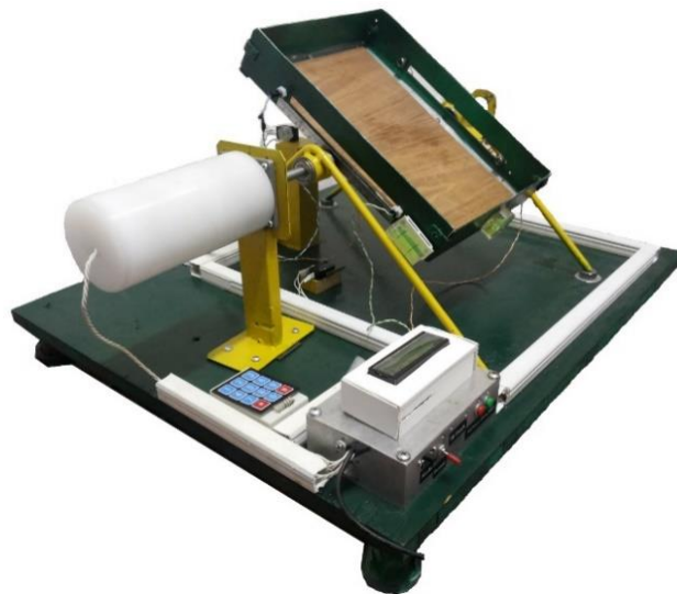
شکل ۴- سامانه ساخته شده برای اندازه‌گیری ضریب اصطکاک استاتیکی و دینامیکی محصولات کشاورزی
