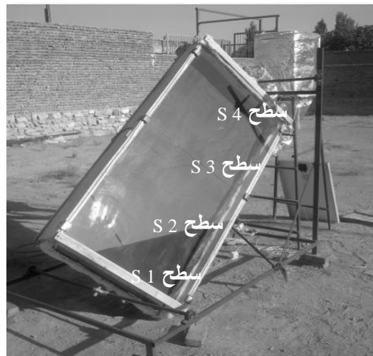
شکل ۲- نماهایی از خشک‌کن خورشیدی شامل صفحه جمع‌کننده، کابینت، پنل خورشیدی و سطوح مشخص شده برای آزمایش
