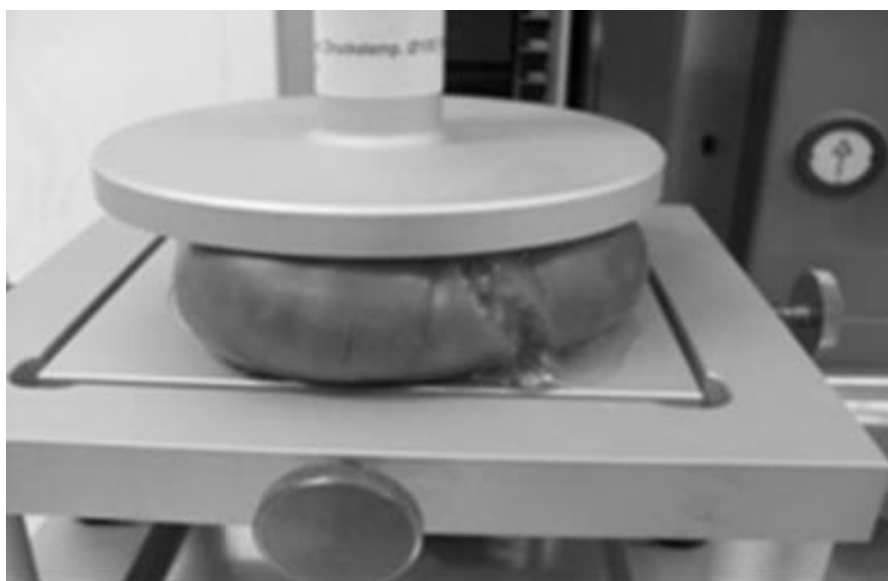
شکل ۲- تست لهیدگی گوجه حین بارگذاری شبه استاتیکی
