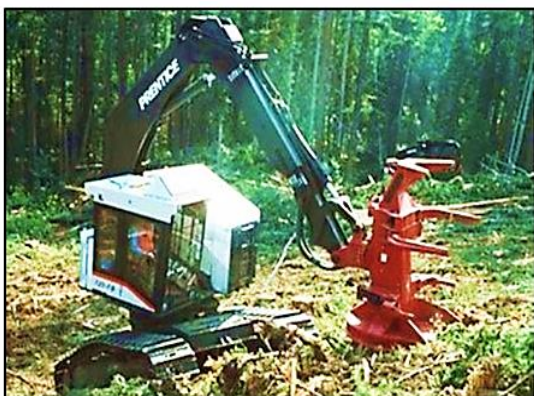
شکل ۱- دو نوع فلربانچر برای برش و حمل درختان در جنگل
