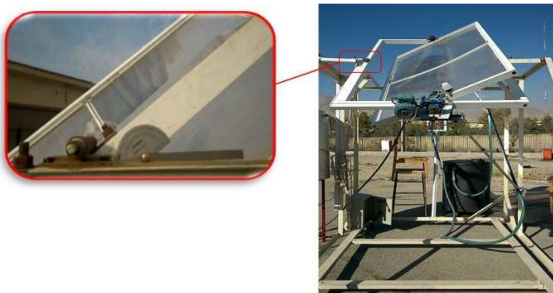
شکل ۱: محل تنظیم زاویه شیب عدسی فرسنل در سامانه.
