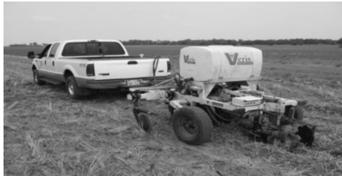
شکل ۴. سکوی متحرک دارای سنسور برای نقشه برداری EC و مدیریت PH
