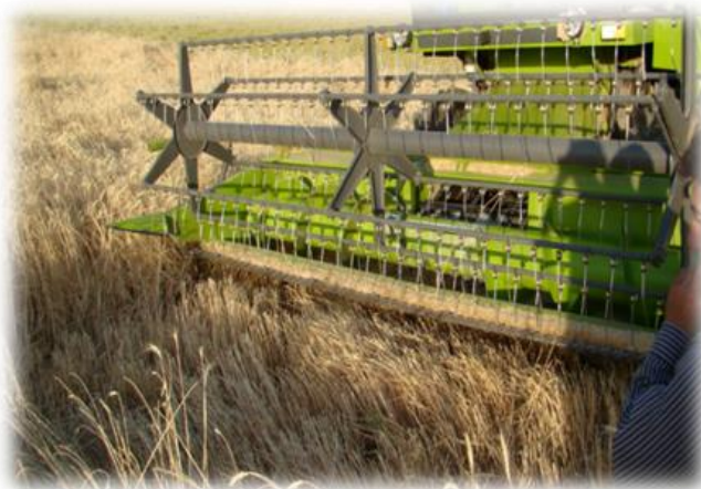
شکل ۴: محاسبه افت دماغه در کمباین K130
