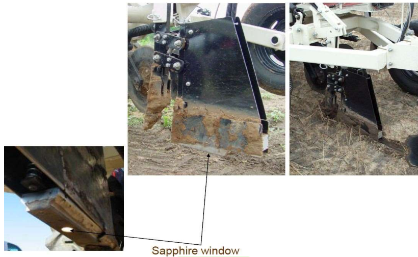
شکل ۳- طیف‌سنج نصب شده روی وسیله متصل به تراکتور
