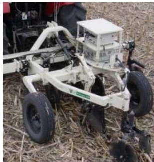
شکل ۲- ساختمان یک طیف‌سنج میله‌ای برای اندازه‌گیری طیف‌های نزدیک
