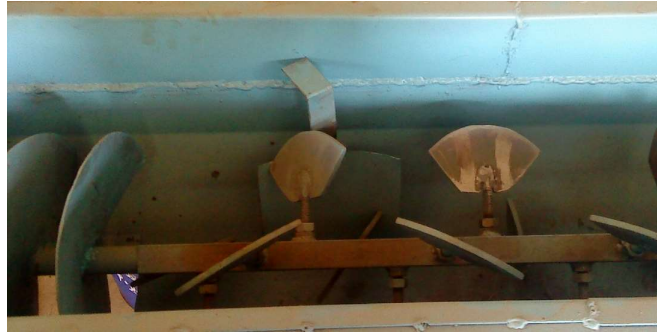
شکل ۲ پدال‌های ورز دهنده و هلیس‌های خروجی
