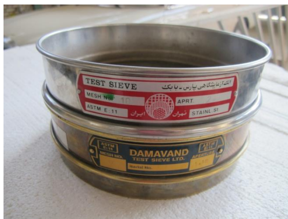
شکل ۳- الک‌های استفاده شده برای اندازه‌بندی کود کمپوست
