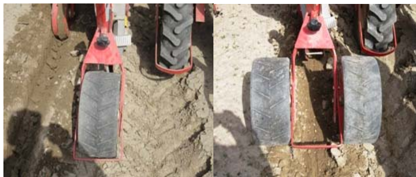
الف- چرخ تغییر داده شده شکل (۱-۳) ب- چرخ موجود روی دستگاه
