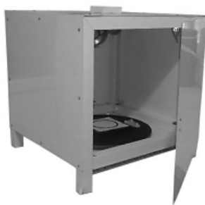
شکل ۱- جعبه عکس برداری استفاده شده برای تامین شرایط مناسب نوری
