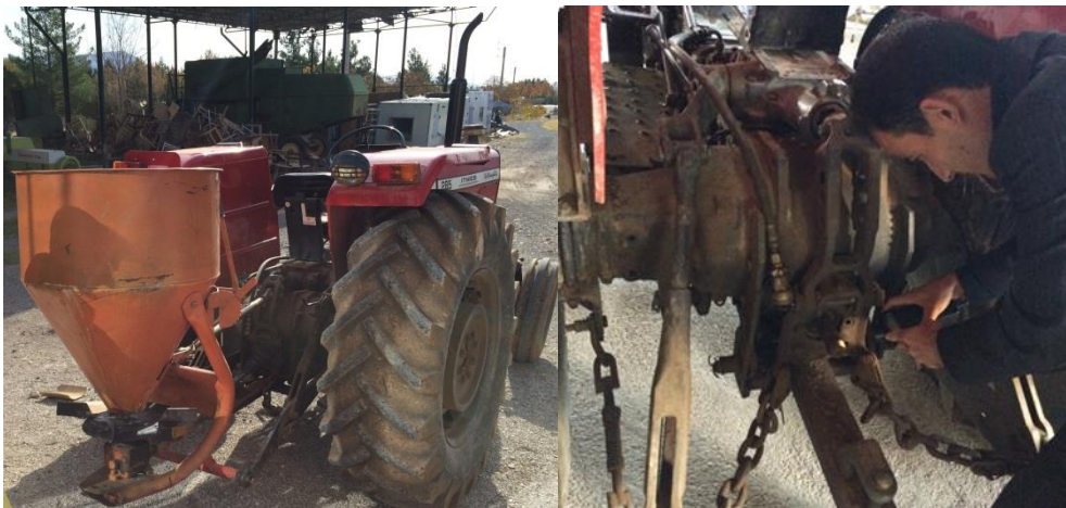
شکل ۱: اندازه گیری دور محور تواندهی و نمای کلی از بذریاش سانتریفیوژ متصل به تراکتور
