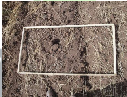
شکل ۱. قاب چوبی برای اندازه‌گیری بقایای موجود در سطح خاک.
