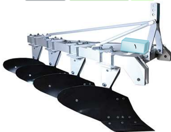
شکل ۸. محل نصب پتانسیومترها و نمایشگرها بر روی گاوآهن، ۱- محل نصب پتانسیومترهای ۳ و ۴ و نمایشگرها
