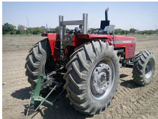
شکل ۳: دستگاه کنترل خودکار موقعیت ادوات کشاورزی نسبت به زمین
