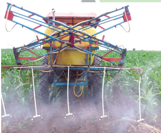
شکل ۴. نمای کلی از سم پاش ساخته شده در حال کار
