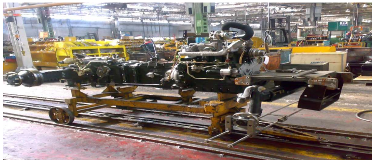
شکل ۱. تراکتور لخت توربو شارژردار ITM485
