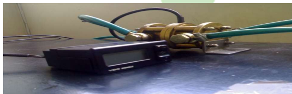
شکل ۴. سوخت سنج و دیتالاگر مورد استفاده در آزمایش
