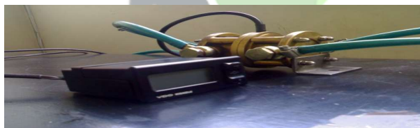
شکل ۳. شکل سوخت سنج و دیتالاگر مورد استفاده در آزمایش
