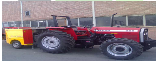
شکل ۴. تست محور تواندهی تراکتور ITM800 دو دیفرانسیل توربوشارژردار توسط دینامومتر Sigma5
