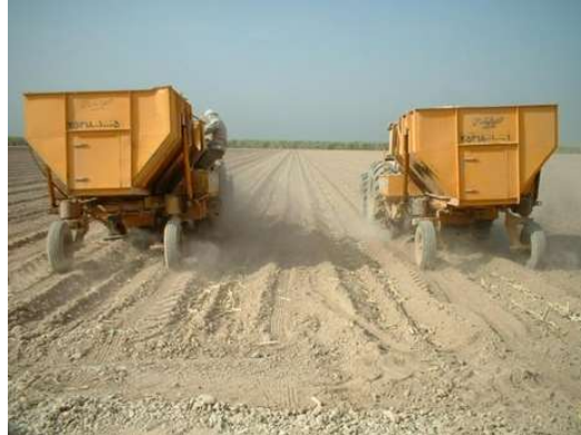
شکل ۱. عملیات کاشت قلمه نیشکر توسط ماشین قلمه کار با اپراتور دوم سوار بر آن
