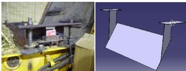
شکل ۲. طرحواره بدنه باسکول و نمونه نصب شده آن در مخزن ثانویه
