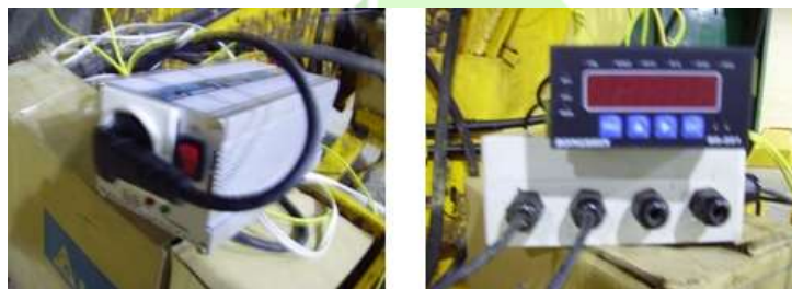
شکل ۳. جعبه رابط لودسل ها، ماژول به منظور برنامه‌ریزی سیستم و مبدل جریان برق ۱۲ ولت DC باطری تراکتور به برق
